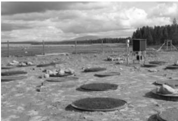
Kuva 3. Luken ja GTK:n lysimetrikokeissa Rautuvaaran kaivoksen rikastushiekkakentällä tutkitaan eri peittoratkaisujen vaikutusta kasvilajien menestymiseen ja maan olosuhdetekijöihin rikastushiekkakerroksessa peittokerroksen alapuolella.
